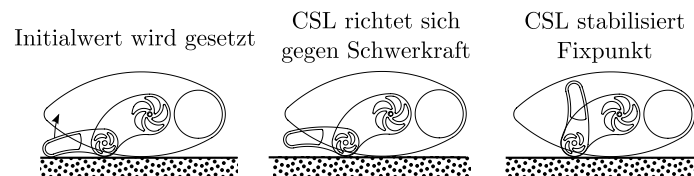
Abbildung 36: Abgebildet ist ein Beispiel für einen Bewegungsablauf, der durch das Verfahren zu Symmetriebrechung beim Umschalten von Release nach Contraction erfolgt. Links wird im stabilen Fixpunkt in den Contraction Modus umgeschaltet und der Integrator mit einem Initialwert gefüllt. Dadurch wird eine Bewegung induziert und die Schwerkraft fängt an dieser entgegenzuwirken. Dies führt dazu, dass sich der Contraction-Modus des CSL gegen die Schwerkraft richtet und den ehemals instabilen Fixpunkt stabilisiert.
